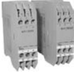
目前市场上的电流电压表大多采用简单的整流加平均电路来完成交流信号的测量，存在较大的理论误差，因此这些仪表测量有效值时只能用于标准不失真正弦波，如果是非正弦波形或者失真正弦波测出的结果与信号实际值就不相符。真有效值变送器采用信号平方后积分的平均技术，它用于标准正弦波或非周期、非正弦波且叠加直流电平的各种噪声的精确测量，无须考虑波形参数和失真，这些性能是平均值测量仪表无法实现的。
